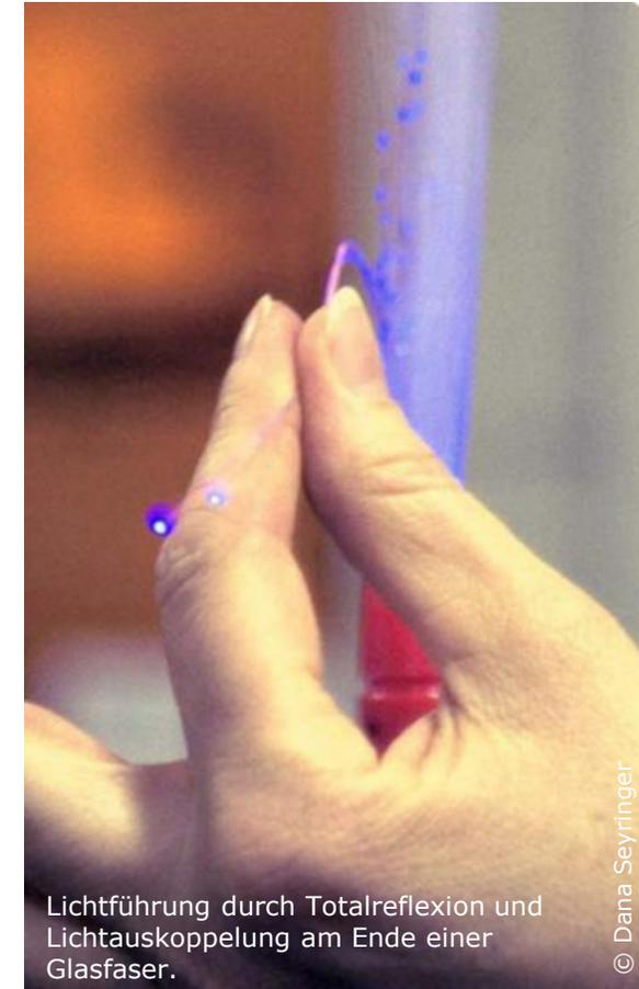
Lichtführung durch Totalreflexion und Lichtauskoppelung am Ende einer Glasfaser.
