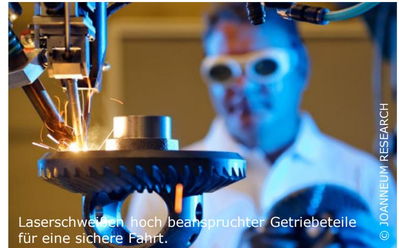
Laserschweißen hoch beanspruchter Getriebeteile für eine sichere Fahrt.
