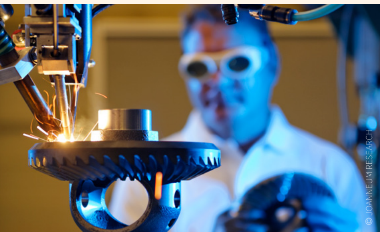
Abb. 4: Laserschweißen hoch beanspruchter Getriebeteile für eine sichere Fahrt.
