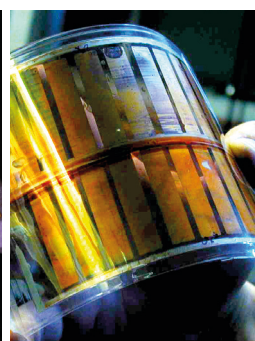
Abb.6: Flexible organische Solarzelle (Foto: Courtesy of Prof. Sariciftci, Linz)
