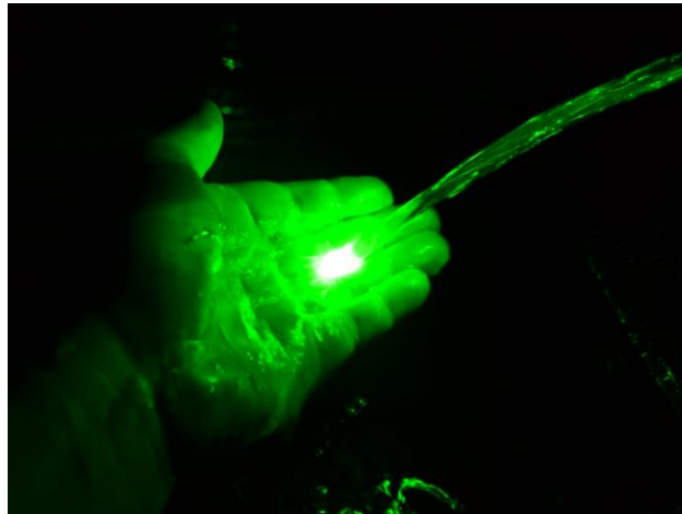
Abb. 1.7: Daniel Colladon hat mit einem einfachen Experiment gezeigt, dass man das Licht, basierend auf Totalreflexion, in einem Wasserstrahl leiten kann.
